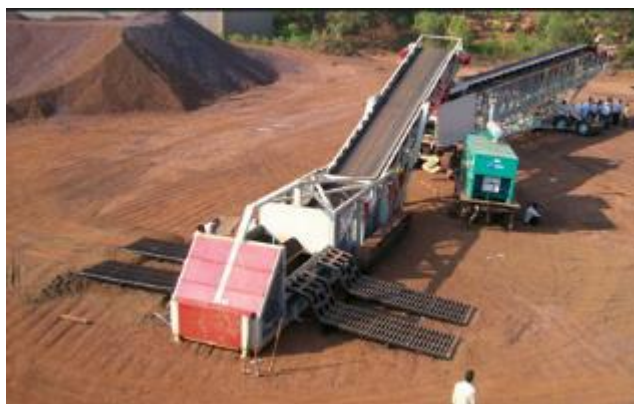
Ilustración 106: Ejemplo de Truck Unloader
