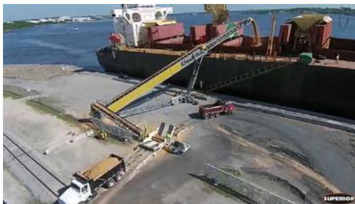
Ilustración 100: Ejemplo de Stacker Telescópico Portátil
