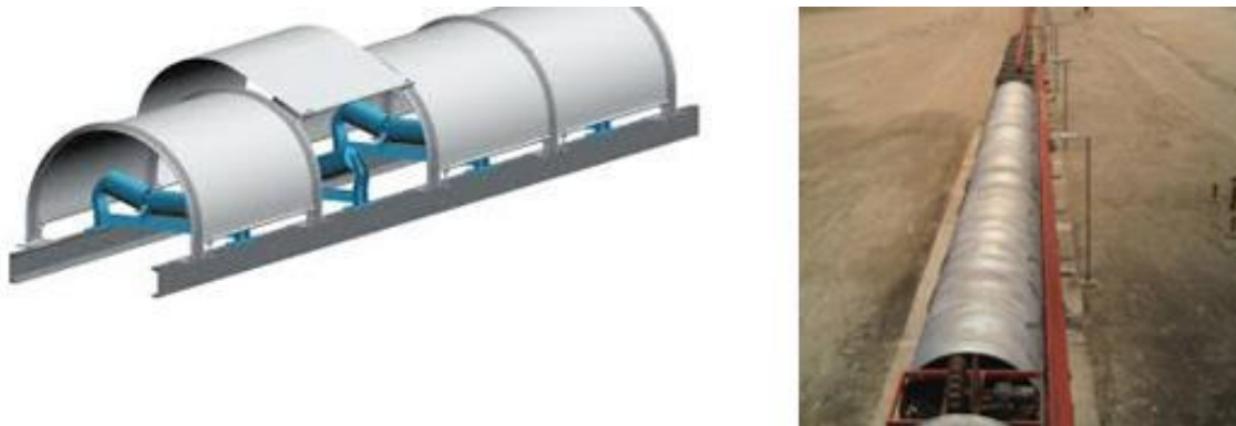
Ilustración 99: Ejemplo de Cinta Transportadora Encapsulada
